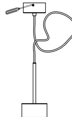
Encaixe a canopla no teto e parafuse nas laterais
