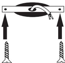
Fixe no teto a chapa de fixação da canopla de acabamento e passe os fios da rede elétrica no furo central
