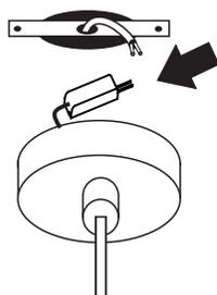
Com a rede elétrica desligada, conecte os cabos do driver e isole com fita isolante anti-chamas
