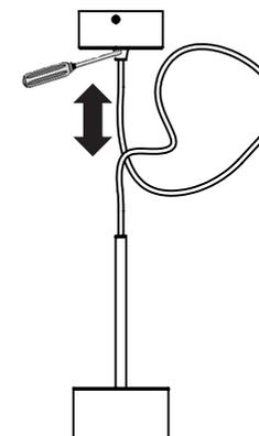
Solte o parafuso lateral do niple para regular a altura do cabo
