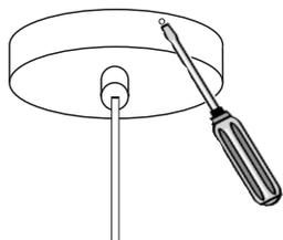
Retire a chapa de fixação no teto soltando os parafusos laterais
